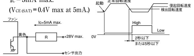
(注：SQ (R) タイプは出力波形が逆になります。) アラーム設定回転速度は、定格回転速度の約半分に設定しています。詳細は納入仕様書をお取寄せの上ご確認ください。
