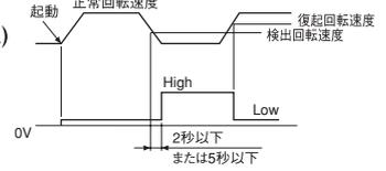
(注：SQ (R) タイプは出力波形が逆になります。) アラーム設定回転速度は、定格回転速度の約半分に設定しています。詳細は納入仕様書をお取寄せの上ご確認ください。
